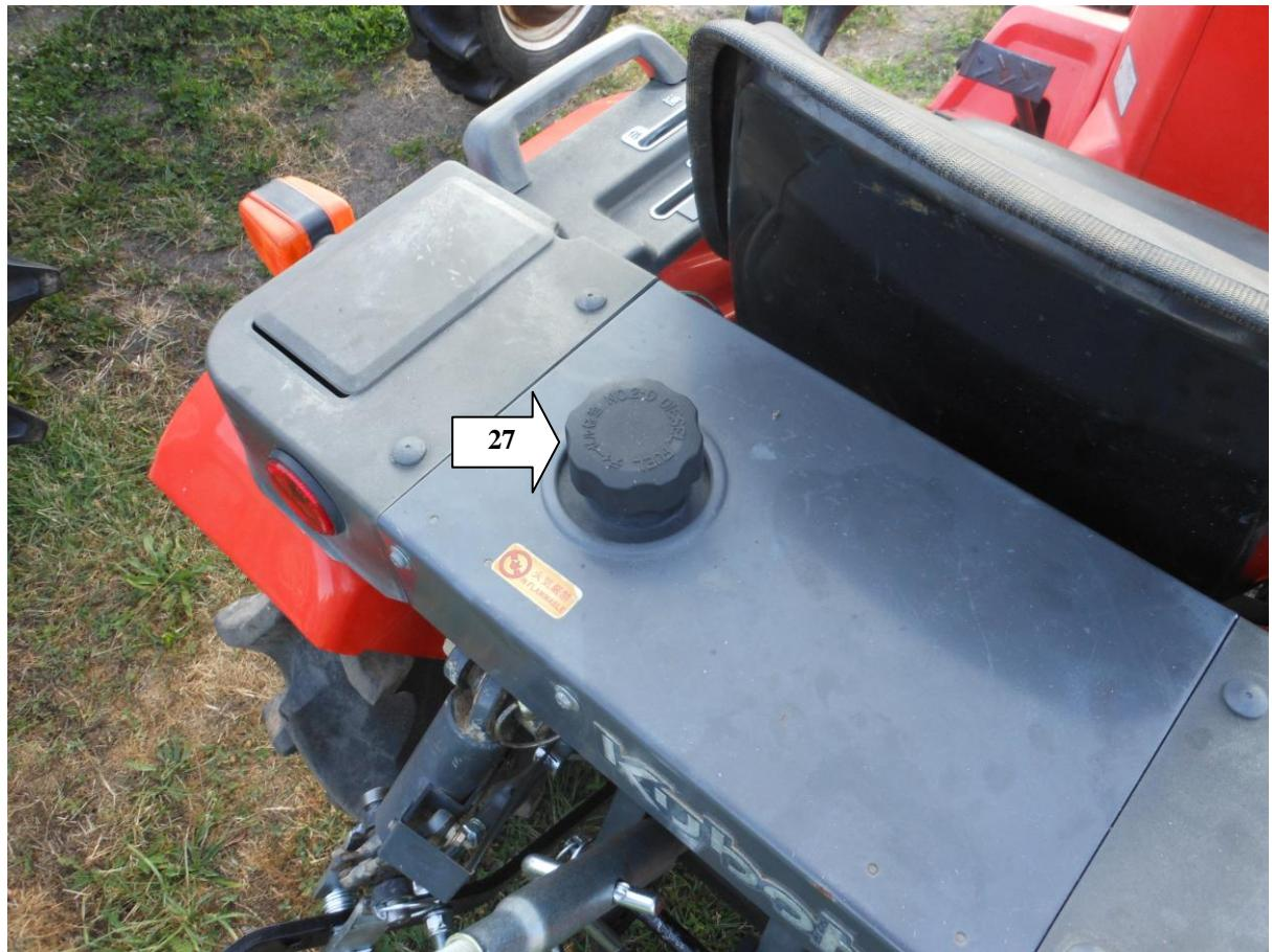
28) Nálevka oleje – převodovka , hydraulika
